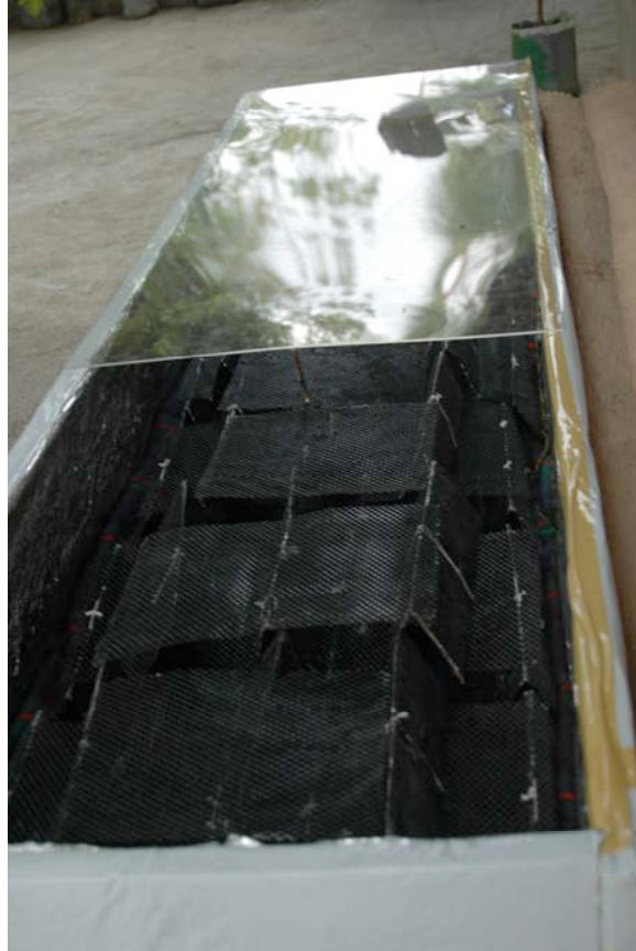
5- Capteur solaire conçu et réalisé par la Fondation le Mabouya. Il est muni de radiateurs, d'absorbeur et de réflecteur
