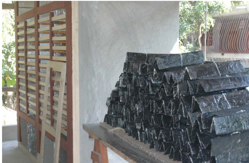
6- A gauche : Chambre de distribution et de séchage (unité pilote) A droite : Radiateur de chaleur en aluminium froissé peint en noir
